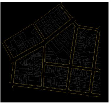
La topología de la red es la distribución planimétrica de los elementos que la conforman: Nodos, Tramos, Embalses, Tanques y Válvulas.
